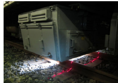
写真3 測定状態（軌道材料モニタリング装置）
