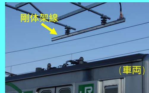
車両と充電設備の組み合わせ試験
