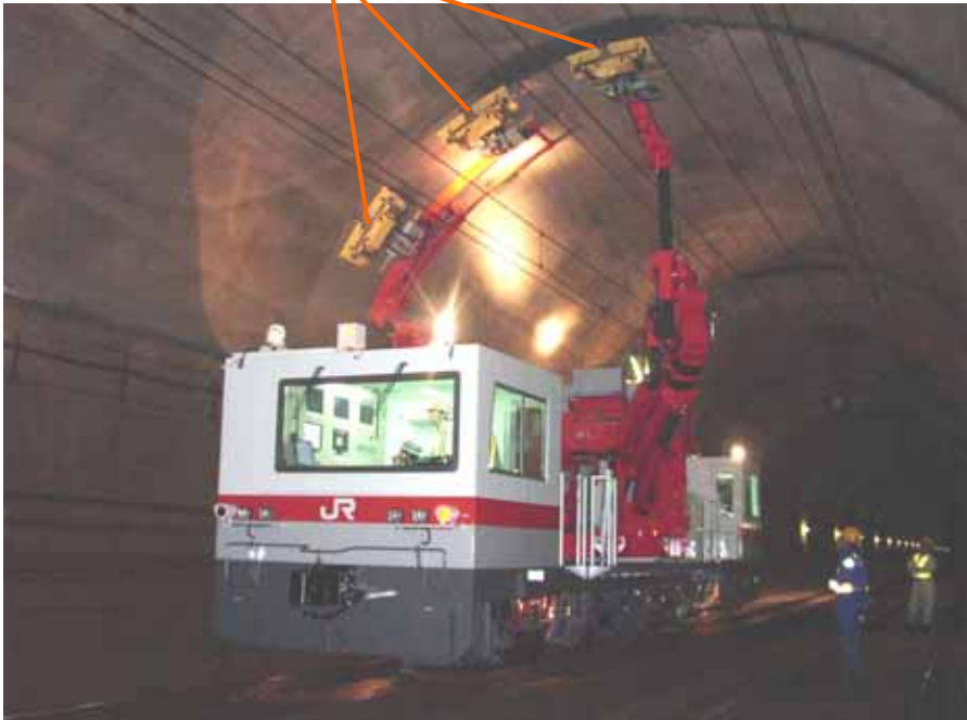
図1 トンネル覆工検査車(トンネル内)
