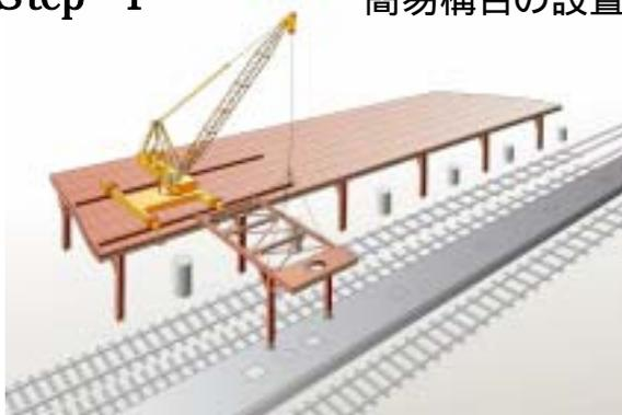
・線路に隣接する用地に仮設構台を設置し、この上に設置したクレーンによって簡易構台を線路上空に架設します。
