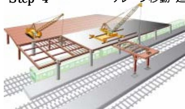
・架設した床版の上にクレーンを移動し、次のスパンを1から3の手順により架設していきます。
