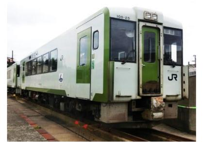
1990年導入以降、東北本線、大船渡線、北上線、釜石線、大湊線で運行しており、最大長は16.5m
