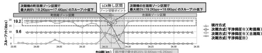
図8 LCXゾーン境界区間 在来線試験車両走行試験 スループット特性(移動速度: 約60km/h)
