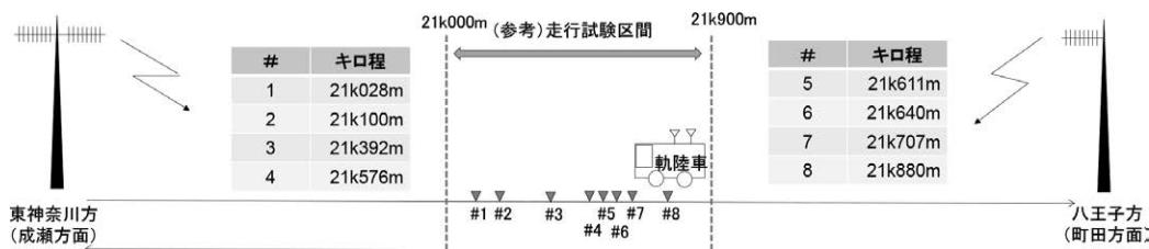
図9 八木アンテナ突合せ区間 軌陸車定置試験 概要図
