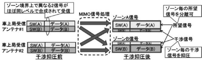
図3 移動局の復調部における干渉抑圧処理のイメージ
