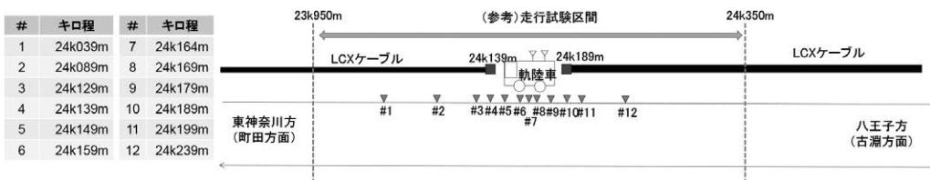
図5 LCXゾーン境界区間 軌陸車定置試験 概要図
