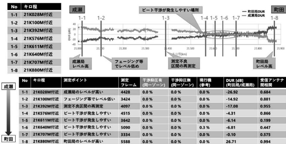
図10 八木アンテナ突合せ区間 軌陸車定置試験DUR分布およびFER特性結果
