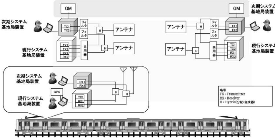
図4 現地試験構成図（在来線試験車両）
