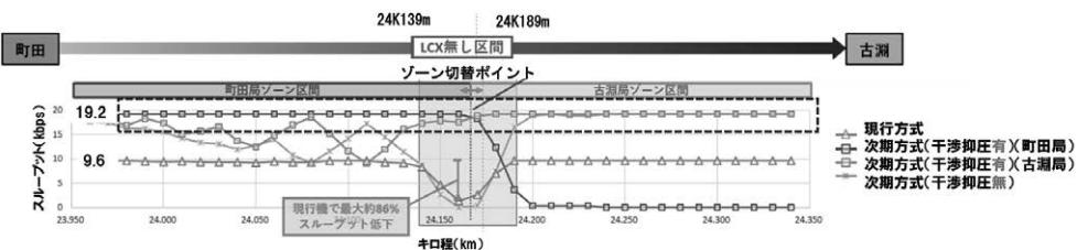
図7 LCXゾーン境界区間 軌陸車走行試験 スループット特性(移動速度: 30km/h未満)
