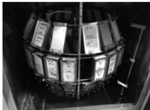
図19 キセノン照射状況の例
