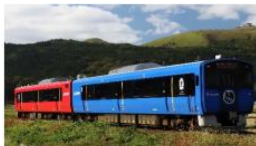
図-2 交流蓄電池電車 EV-E801 系車両外観
