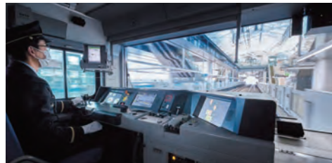
■山手線E235系の自動運転を目指した実証運転
