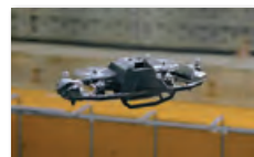
小型ドローンによる点群データ等の取得
