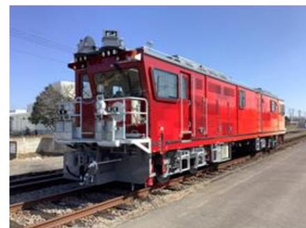
新幹線線路設備モニタリング車
