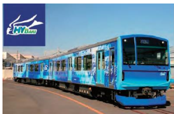
水素ハイブリッド電車HYBARI 実証試験中
