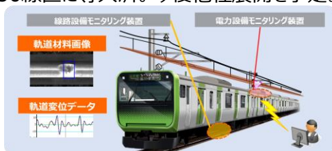
CBM（地上設備モニタリング）
