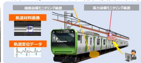
CBM（地上設備モニタリング）
