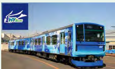
水素ハイブリッド電車 (HYBARI) の開発 Development of hydrogen-powered train (HYBARI)
