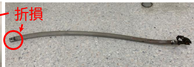
脱落した架線金具
