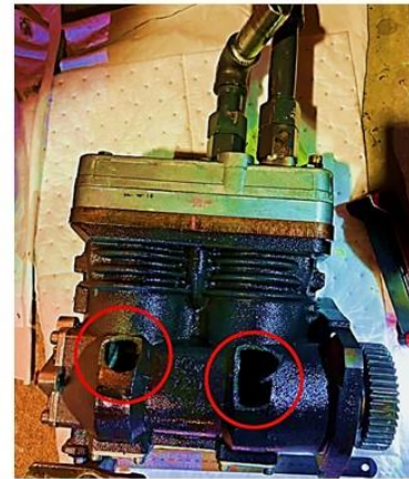
【コンプレッサー破損箇所】
