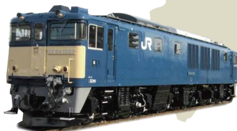
電気機関車 (EL) 電力を動力源に客車を牽引します。高崎支社内には主に勾配線区で活躍した「EF64形」と、かつてブルートレインなどを牽引した「EF65形」の2種の電気機関車が所属しており、「ELぐんま よこかわ」などの臨時列車を牽引しています。
