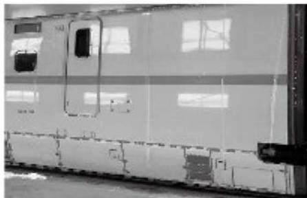
図1 E5系新幹線における側ふさぎ板の取り付け位置
