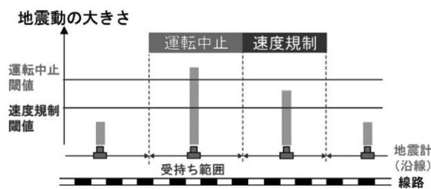
図4 沿線地震計による運転規制(イメージ)
