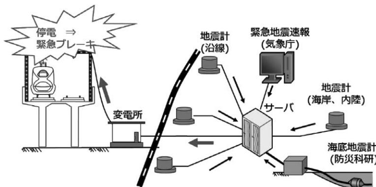
図2 新幹線早期地震検知システムの概要
