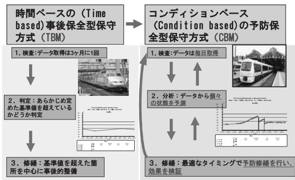
図1 TBMとCBM概念図
