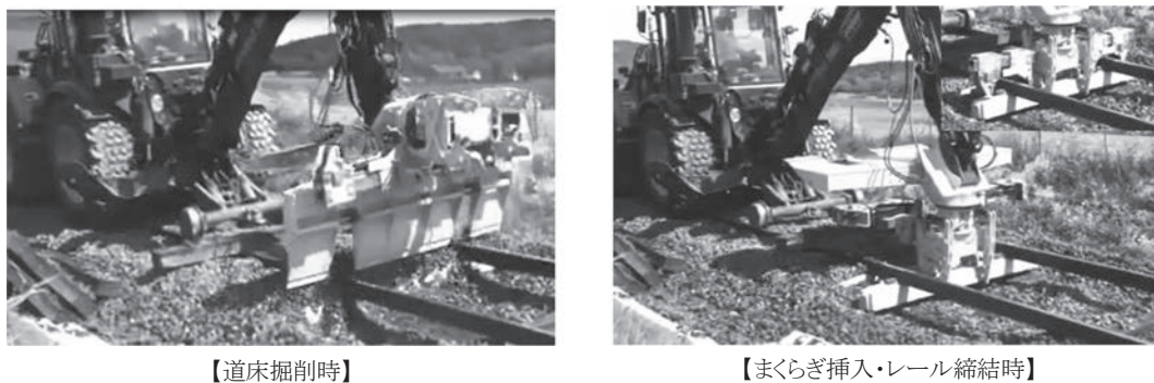
図4 海外で使用されている専用機械(SB60) 出典元:住友商事(株)HPより
