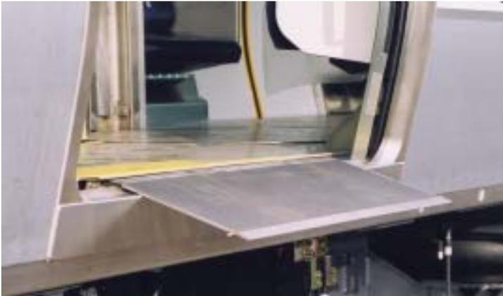
床中からスロープ板が出てきて段差・隙間を解消
