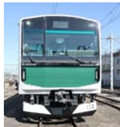
EV-E301系 蓄電池駆動電車 (ACCUM)
