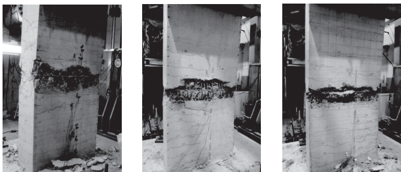
図5 10 \delta y (変位160mm程度) 時のピッチによるひび割れ比較
