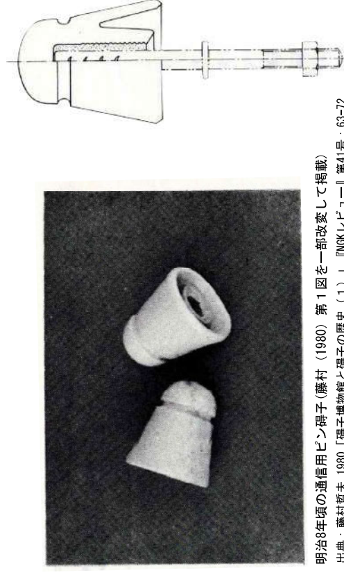
図6 3区盛土A下部から出土した罫子実測図(上段)と国産罫子(下段)
