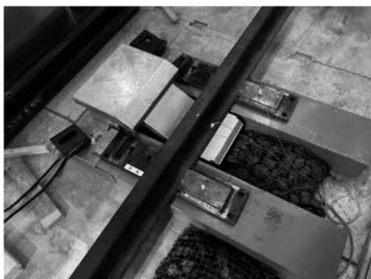
図7 レール温度上昇試験の様子
