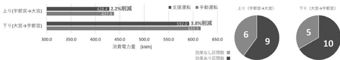
図5 上下線別の走行試験における消費電力量の測定結果
