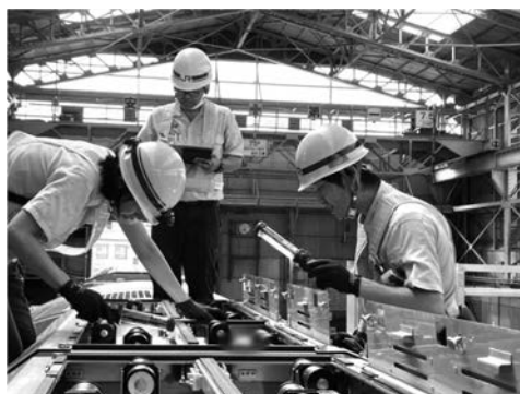
図4 容器再検査の実施（水素貯蔵ユニット内の水素容器および附属品に対する外観検査）
