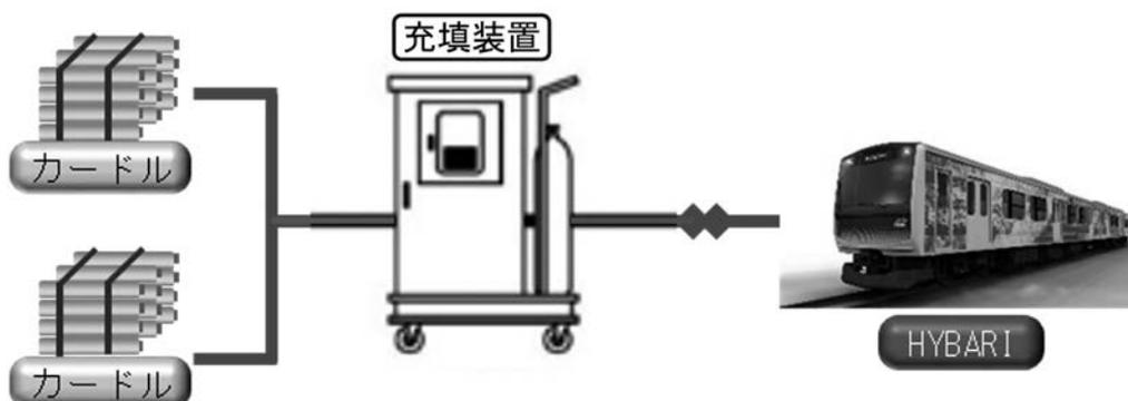
図4 35 MPa水素充填時の構成
