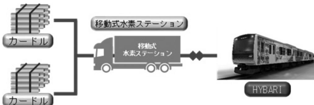
図5 70 MPa水素充填時の構成
