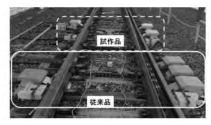
図9 訓練線での試作品実証試験の様子
