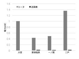
図3 温風融雪器1個分の消費電力測定結果
