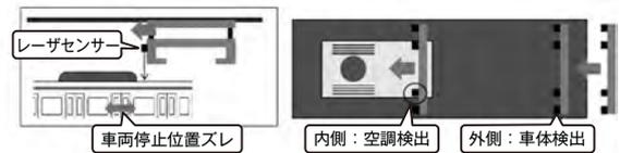
図5 レーザーセンサーによる空調装置位置検出
