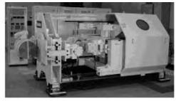
図5 車輪・レール転動試験装置
