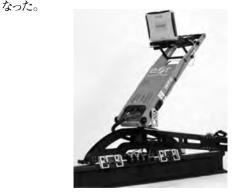
図9 渦電流探傷装置
