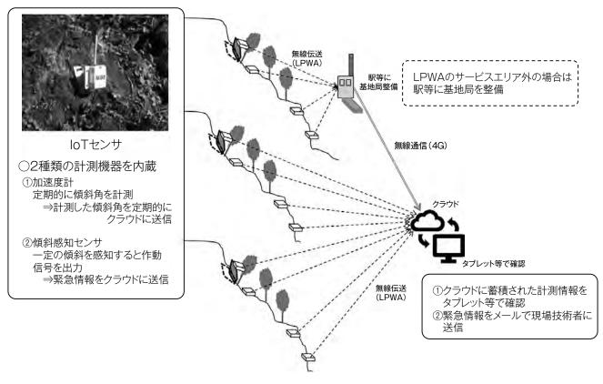
図2 無給電傾斜センサの概要
