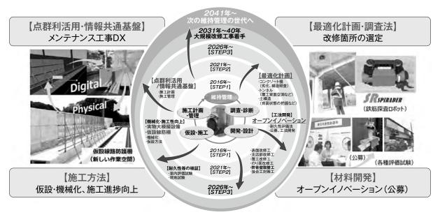
図1 新幹線大規模改修工事に向けた技術開発のコンセプト (フロンティアサービス研究所)
