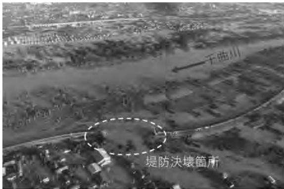
図3 台風19号による千曲川の堤防決壊状況 (2019年10月13日16時30分頃撮影)
