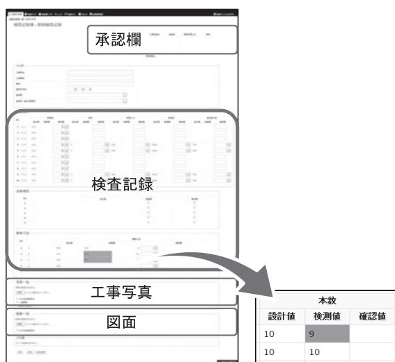
図6 ツールでの検査記録簿の構成と規格値判定状況
