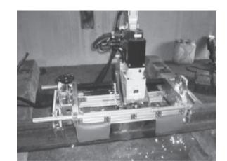
図8 レール溶接仕上げ用機械による削正状況
