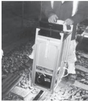
図8 実際の探傷状況
