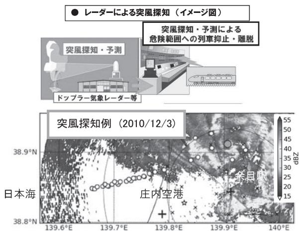
図6 ドップラーレーダーによる突風検知の研究
