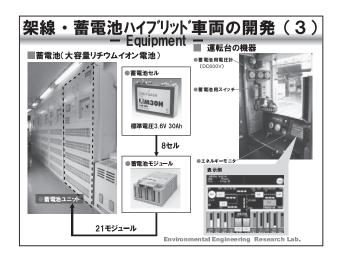
車両に搭載する蓄電池は3.6ボルトのリチウムイオン電池を8セル積んでモジュールとし、21モジュール積んで600ボルトのユニットを構成しております。当初9ユニットを積んでいましたが、現在はより実用化に近い4ユニットで試験を継続しています。
