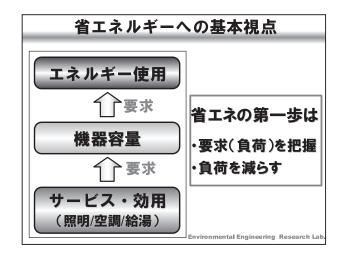
何故エネルギーを使用するのかというと、それは人が照明、空調、給湯などのサービス・効用を要求するからです。サービス・効用は、それを実現する機器の容量を要求し、機器の容量が大きくなれば、それだけエネルギー使用も大きくなります。
