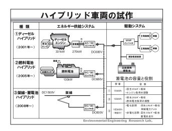
次に、ハイブリッド車両の試作について報告します。 2001年から2010年にわたり、ディーゼルハイブリッド、 燃料電池ハイブリッド、架線・蓄電池ハイブリッドの3種 類のハイブリッド車両を試作してきました。
