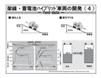
日光線は電化区間ですが非常に急勾配であるため、 現行の車両では、坂を上るときに架線電圧が下がると か、逆に坂を下りるときには、車両が古いのでブレーキ 時の発電エネルギーを抵抗器で熱として捨てるしかな い悩みがあります。この悩みを、架線・蓄電池ハイブリッ ド車両で解消できるということが分かりました。
