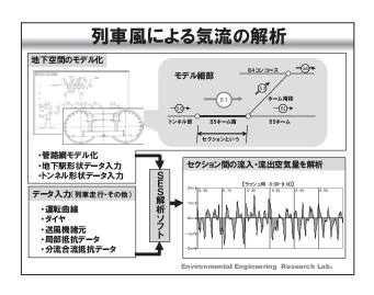
次に、列車風による気流を解析しました。このように 地下空間を管路としてモデル化し、SESという解析ソフトにより列車風による気流を解析しました。
