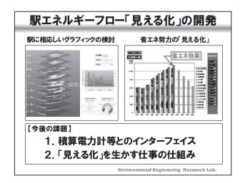
そこで、システム作りとしてまず駅のエネルギーフローの「見える化」の開発を行いました。駅にふさわしいグラフィックの検討と、エネルギーが「見える」だけではなく、省エネ努力が見えるように分析ツールの検討を進めてきました。今後は現地の積算電力計とのインターフェースの構築や、「見える化」を生かす仕事の仕組み作りが課題となります。
