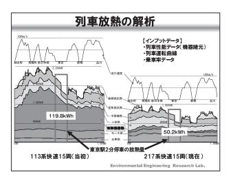
ゾーン内で発生する熱の具体例の1つとして、総武地下ホームにおける快速列車の列車放熱を解析したものです。古い113系車両では抵抗制御車のため、ブレーキ時のエネルギーを熱として抵抗器から放熱していました。一方、現行の217系車両では回生ブレーキを用いたことにより制御機熱が大幅に減少しており、また全体として見ても列車放熱が半分以下になっていることがわかります。このように昭和40年代の条件と比較してみると、ゾーン内で発生する熱が大きく変わっていることが明らかになりました。
