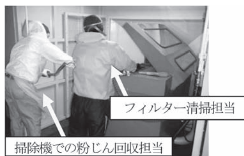
図3 現在のロールフィルター清掃作業
