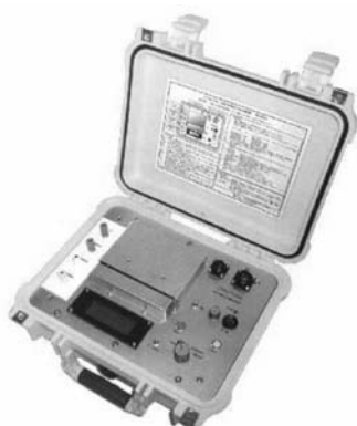
図8 開発した変電所接地装置健全性確認試験器
