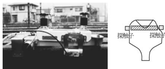
図5 レール頭側部からの透過法による探傷
