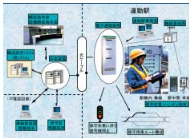
図2：ATOS保守作業管理システム
