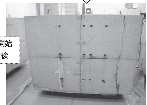
図11 枅形試験体漏水状況変化 (配合②)
