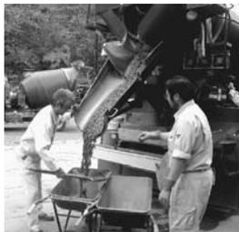
図10 アジテータ車からの卸し状況 (試験用)
