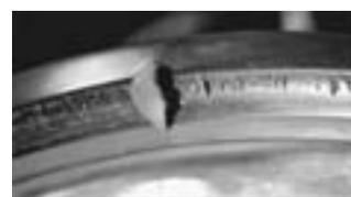
図5 レール頭部の部分的脱落
