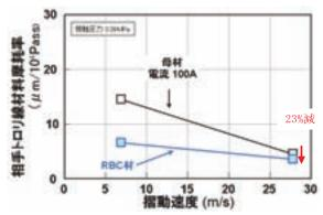
図17 相手トロリ線材料の摩耗率 (パンタグラフの単位通過回数あたりのトロリ線摩耗厚さ)
