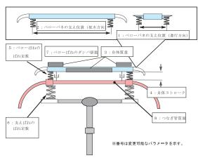
図2 ベンチテスト用パンタグラフの概要
