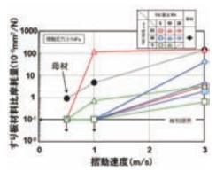
図13 摺動速度と比摩耗量の関係
