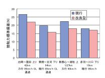
図5 接触力標準偏差算出結果(10径間約500m)
