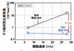
図16 すり板試験片の比摩耗量
