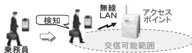
図3 無線LANによる位置検知
