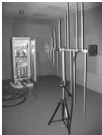
図14 EMC試験(電磁ノイズ放射)
