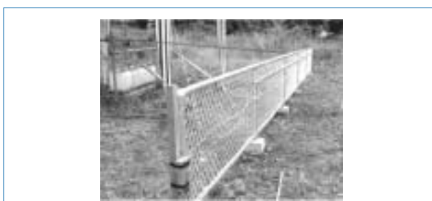
図24：フェンス基礎寸法の試験状況
