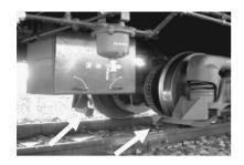
図2 車上式レール途油器
